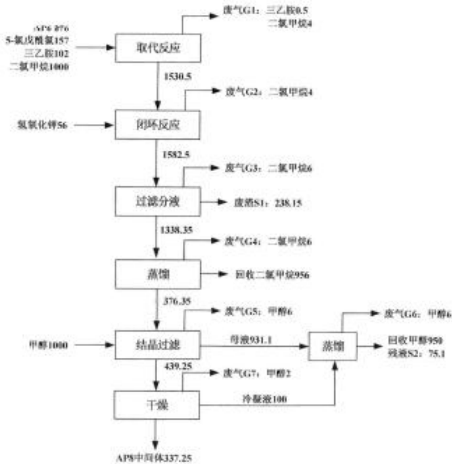
图 4.2.5-1 AP8 中间体生产工艺流程图 (kg/批)
